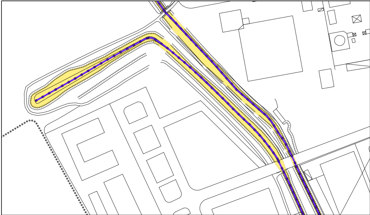
Figura 6. Esempio di digitalizzazione dell'Area tra le sponde per il tratto del RIM 03015211_0013, Fontanile Sera e Mattina e per il tratto 03015211_0014, Fontanile Facchetti (linee viola corrispondono alla mezzeria dei canali).
